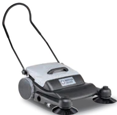
Die Handkehrmaschine SM800 ist die ideale Lösung für kleine Flächen im Innen- und Außenbereich. Sie nimmt Schmutz wie Staub, Sand, Kies, Dosen, Kronkorken oder Zigarettenkippen durch das Überwurfkehrprinzip mühelos auf. Die Kombination aus zwei Hauptkehrwalzen und zwei Seitenbesen macht die Maschine äußerst effizient – damit kehren Sie fünfmal schneller als mit einem herkömmlichen Besen. Für eine besonders lange Lebensdauer sorgt die stabile und korrosionsbeständige Konstruktion der SM800.
